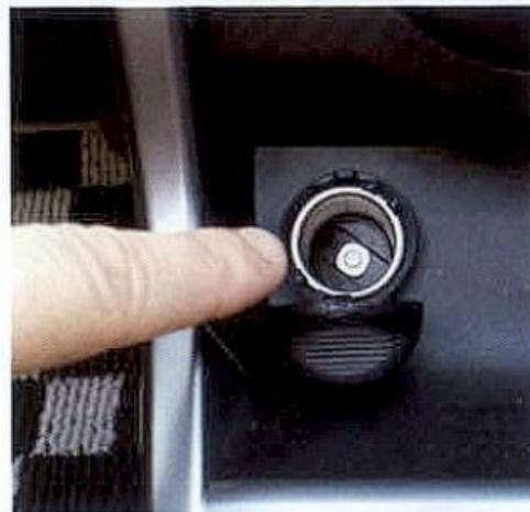
付属のシガープラグコードを接続します。シガープラグコードのType-C端子側を本体に接続します。
